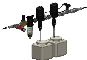
Installation avec double injection à distance
