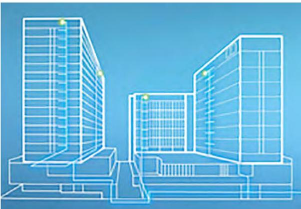
Exemple d'un immeuble collectif et tertiaire avec réseau d'eau généralisé. Il peut être difficile de déterminer le point, c'est pourquoi un ensemble de six capteurs maximum suffit à couvrir la totalité du réseau.
