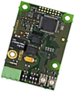
Les modules d'interface de communication (CIM) Grundfos permettent la communication via tous les bus de terrain pertinents.
