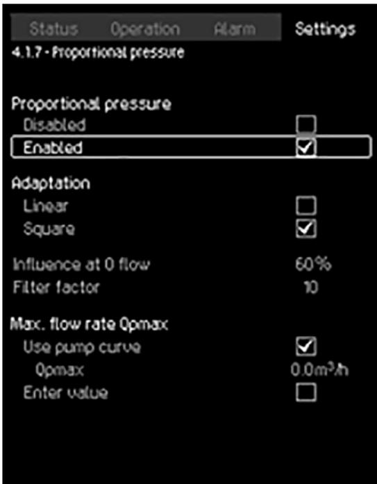
Menu de configuration de la pression proportionnelle du groupe Hydro MPC. Un débit maximal peut aussi être défini. Cela permet de garantir que le débit du réseau ne dépasse pas son débit nominal.
