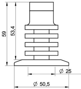
Tri-Clamp Ø 50.5, membrane Ø 25 mm (BCID: C04) avec col de refroidissement
