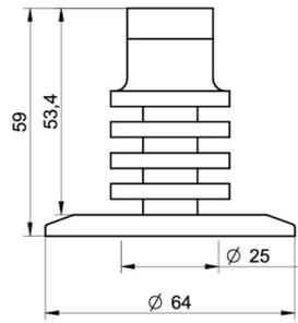
Tri-Clamp Ø 64.0, membrane Ø 25 mm (BCID: C05) avec col de refroidissement
