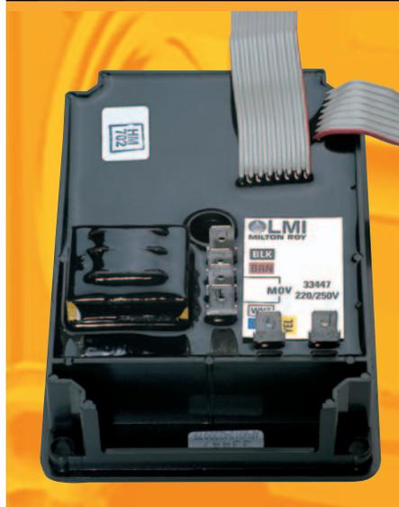
Le circuit de commande est noyé dans la résine epoxy et toutes les connexions internes sont réalisées par cosses débrochables isolées. Cette technique assure une excellente résistance aux vapeurs corrosives et aux vibrations.
